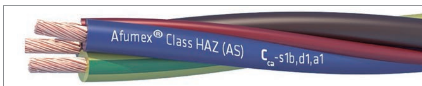
> Cable Afumex Class Haz (AS) es especial para derivaciones individuales con el hilo rojo de 1,5 mm 2 para mando. Siempre se ha suministrado la formación con este hilo de mando que vuelve a ser obligatorio.
