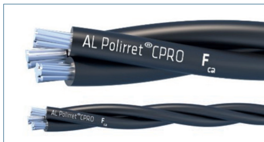
> Al Polirret CPRO con conductores de Aluminio y neutro fiador de Almelec en algunas formaciones. Diseñado según UNE 21030-1 para instalación en redes de distribución aéreas tensadas o posadas.
